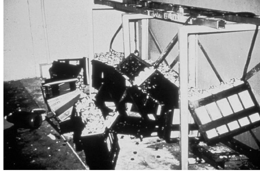
Fotografía 5-5. Ejemplos de falta de anclaje lateral y deslizamiento de objetos
